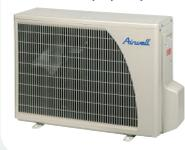
La structure en matériau polyester thermostable permet la réduction des niveaux sonores, du poids et allongement de la durée de vie (GCNG). Le traitement anticorrosion avec revêtement peinture poudre High density assure une haute résistance quelles que soient les conditions de fonctionnement.
