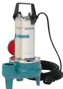
Pompe de relevage à roue vortex. Pour eau chargée. Corps de pompe et turbine en fonte cataphorèse. Moteur et arbre en inox 304. Double garniture mécanique en céramique d'alumine/carbone dur/NBR, dans chambre à huile. Moteur à sec 2900 tours/minute (service continu).
