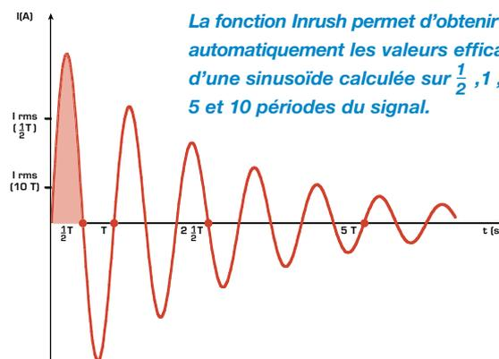
La fonction Inrush permet d'obtenir automatiquement les valeurs efficaces d'une sinusoïde calculée sur  $\frac{1}{2}$ , 1, 2  $^{1/2}$ , 5 et 10 périodes du signal.
