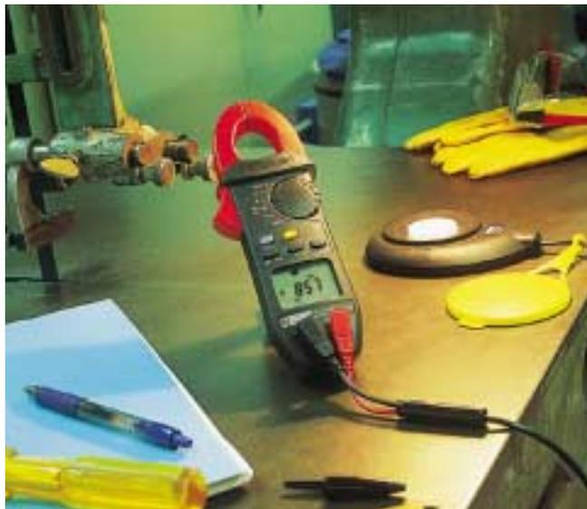
Grâce à la fonction adaptateur de la pince F07, la mesure de grandeurs physiques devient extrêmement simple : la mise en mémoire par décades du facteur d'échelle permet une lecture directe de la mesure.
