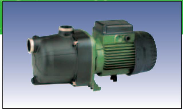
Pompe centrifuge auto-amorçante ayant d'excellentes capacités d'aspiration même en présence de bulles d'air. Adaptée à l'utilisation avec de l'eau contenant des petites impuretés sableuses. Particulièrement indiquée pour l'alimentation en eau dans des installations domestiques : transfert d'eau agressive en général contenant du chlore (eau de piscine). Corps pompe en technopolymère.
