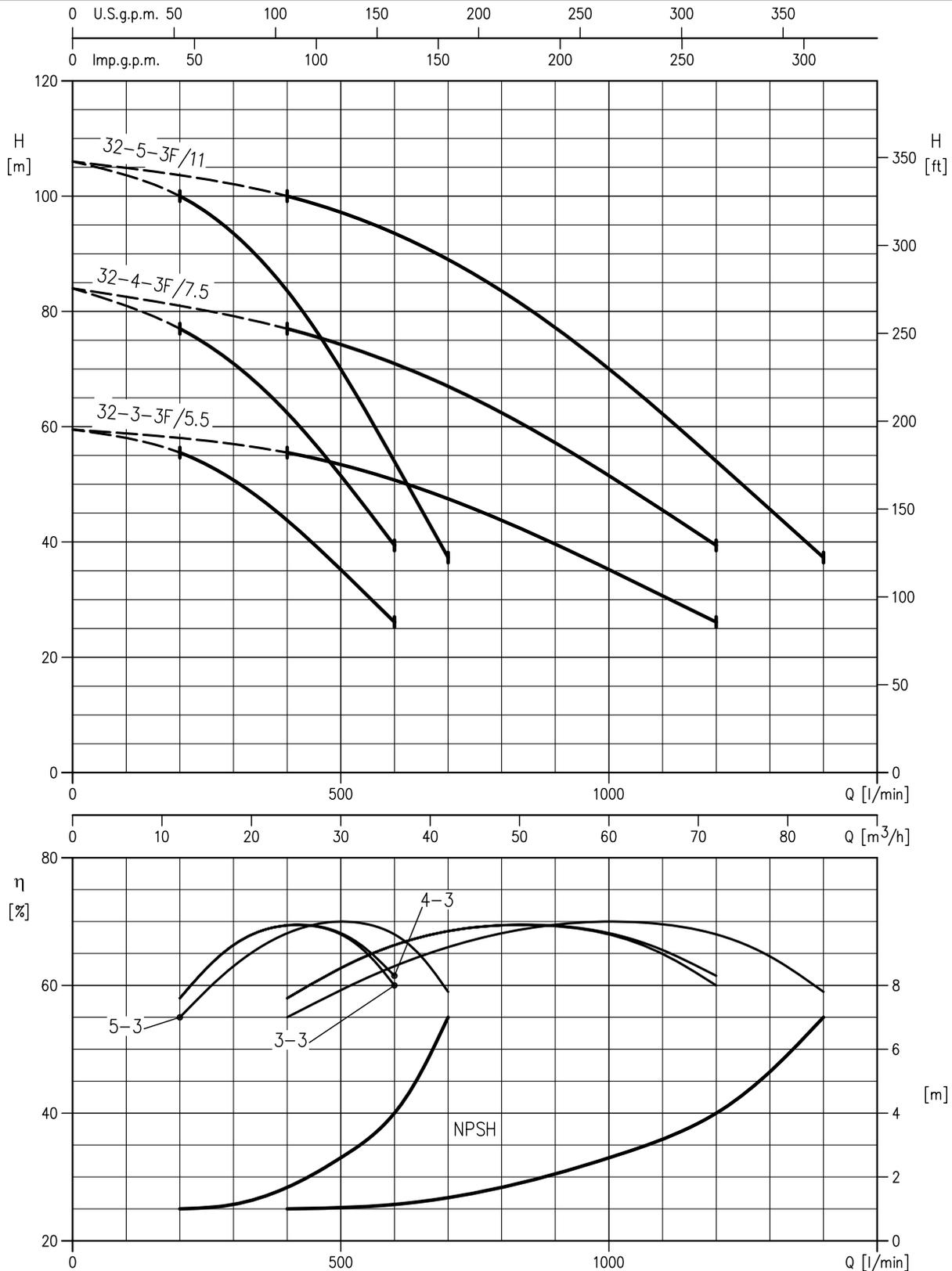
Les caractéristiques indiquées ne comprennent pas les pertes de charge dans les vannes et la tuyauterie. Le NPSH indiqué est un NPSH de laboratoire rapporté à la pompe.
