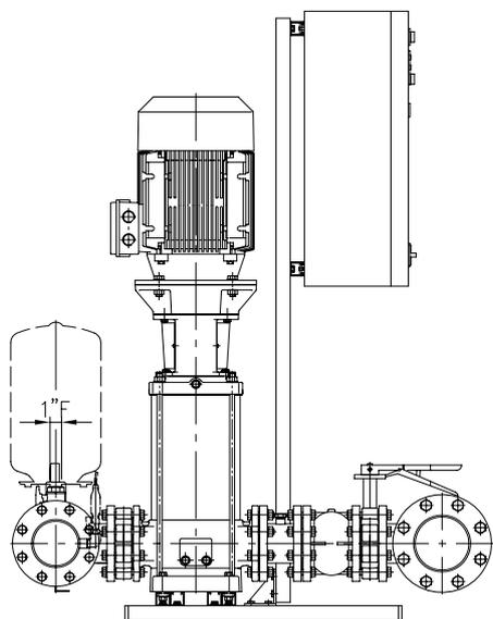
Groupes avec deux pompes multicellulaires verticales avec hydrauliques en acier inox avec moteur normalisé.
