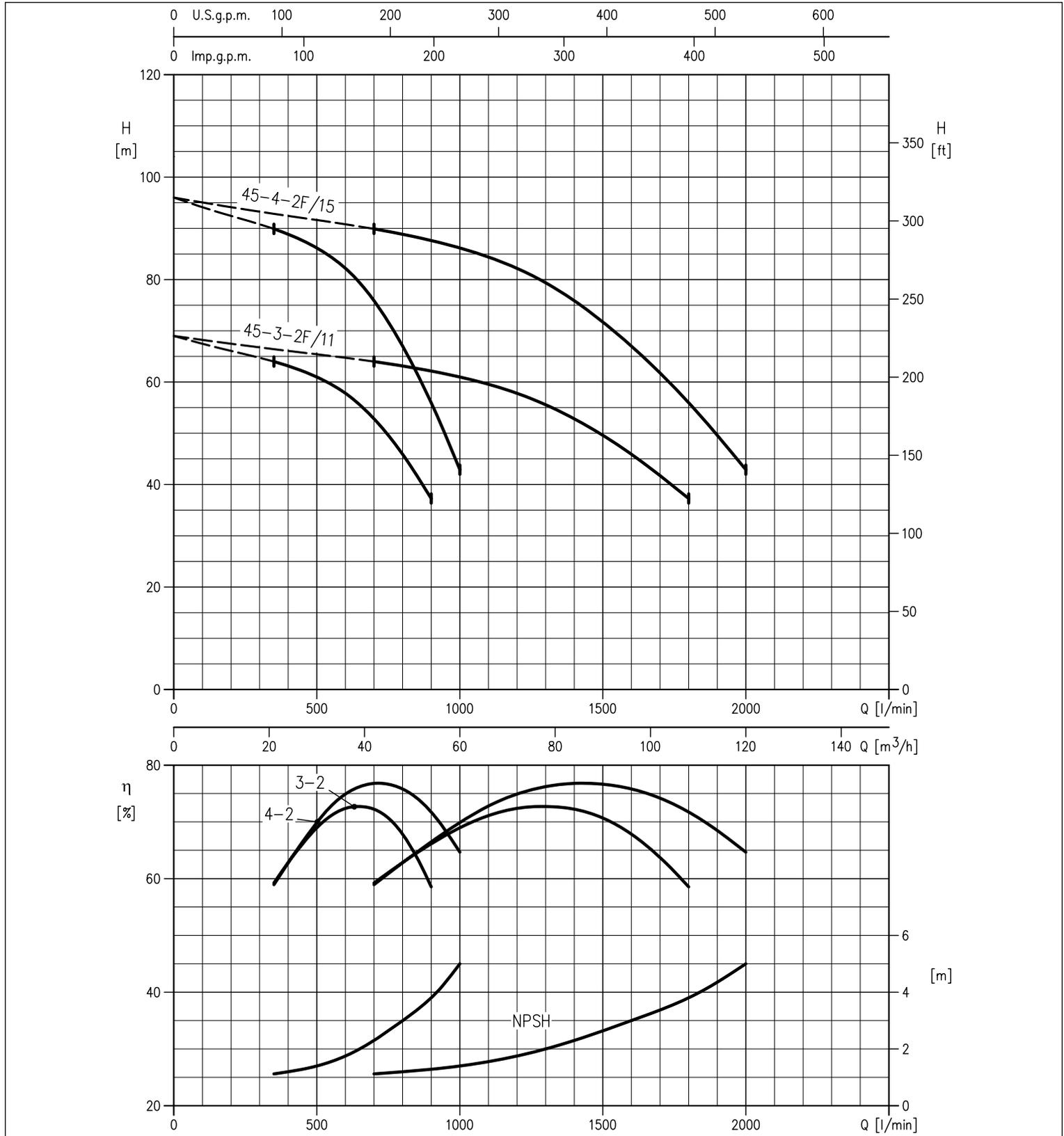
Les caractéristiques indiquées ne comprennent pas les pertes de charge dans les vannes et la tuyauterie. Le NPSH indiqué est un NPSH de laboratoire rapporté à la pompe.
