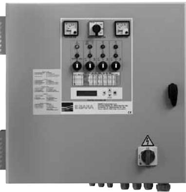
Les coffrets de commande avec variateur de la série SP modulent le fonctionnement des électropompes en répondant à la commande du transducteur de pression (transducteur de débit ou autre signal extérieur de 4-20 mA), régulant ainsi la vitesse des électropompes en fonction des besoins de l'installation.
