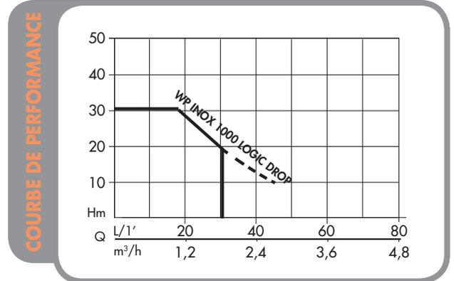
**Modèle:** WATERPRESS INOX 1000 LOGIC DROP
