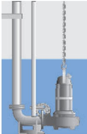
Installation immergée semi-permanente, avec double barre de guidage et pied d'assise.
