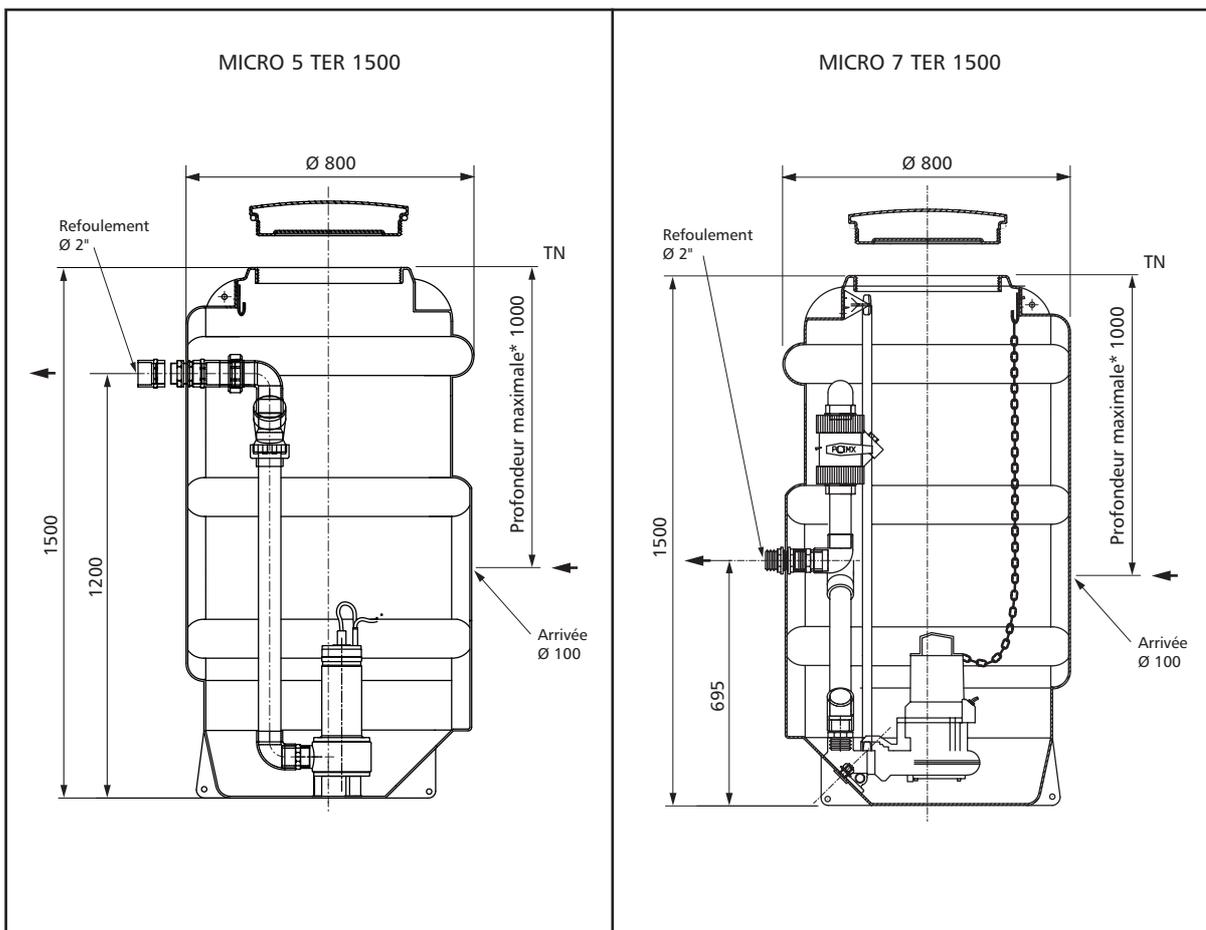
\* Profondeur maximale du fil d'eau d'arrivée par rapport au niveau TN (Terrain Naturel)
