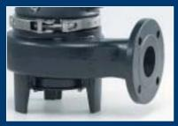
Raccordement sur tuyau souple ou bride Selon le modèle, les pompes de relevage Grundfos sont équipées soit d'un raccordement taraudé 2", soit d'une bride en DN 65, PN 10. Les pieds du corps de pompes diminuent fortement les risques de bouchage à l'aspiration.
