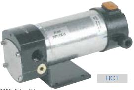
Pompe à engrenages courant continu, viscosité de 50 à 2000 cSt (mm²/s) Utilisation par intermittence durée max. 30 mn.
