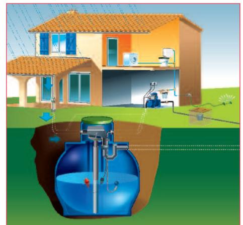
La cuve, livrée avec un équipement complet, peut recevoir une pompe immergée ou une pompe de surface (non fournie)
