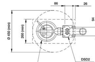
DRENAG 1400 M Dimensions minimum du puisard pour installation avec système de relevage DSD2 (vue de dessus).
