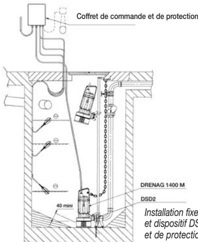
Installation fixe avec une pompe DRENAG 1400 M et dispositif DSD2, coffret de commande et de protection et deux interrupteurs de niveau MINI et MAXI + flotteur d'alarme.
