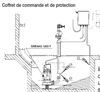
Installation fixe avec une pompe DRENAG 1800 T, coffret de commande et de protection moteur, un interrupteur de niveau MINI / MAXI et un flotteur alarme.
