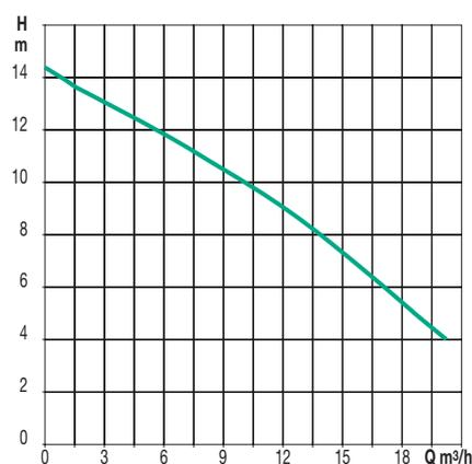
Les courbes de caractéristiques sont basées sur des valeurs de viscosité cinématique = 1 mm<sup>2</sup>/s et densité égale à 1 000 kg/m<sup>3</sup>.
