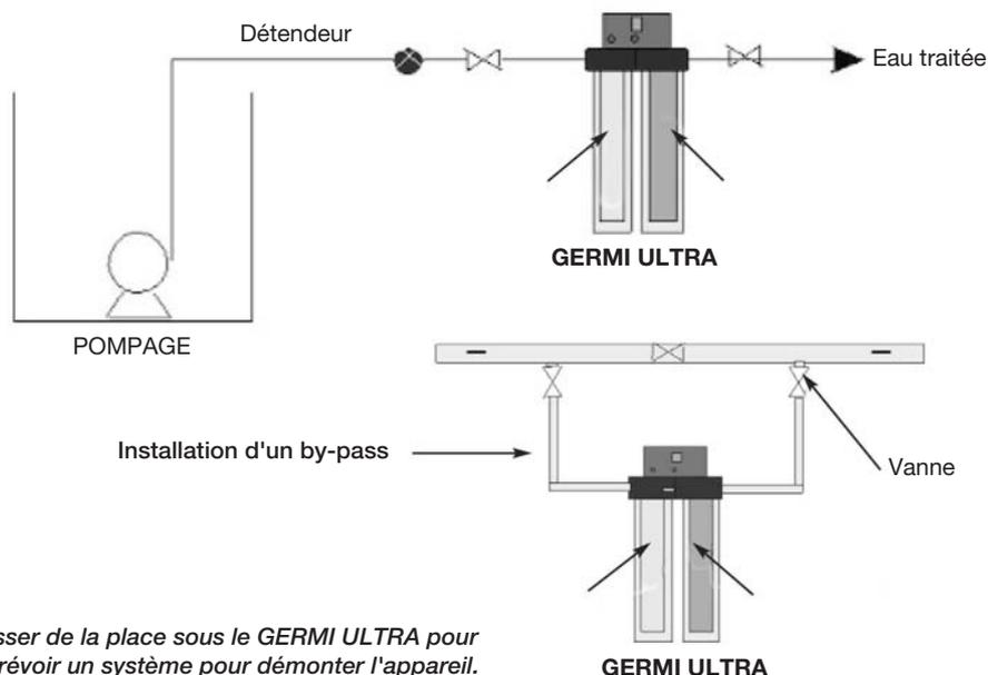
*Il est nécessaire de laisser de la place sous le GERMi ULTRA pour sortir la lampe ou de prévoir un système pour démonter l'appareil.*
