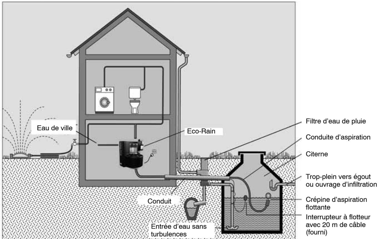
Schéma d'installation de la station Eco-Rain avec citerne enterrée à l'extérieur du bâtiment
