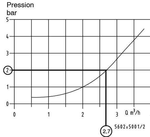
La pression de refoulement de la pompe (manomètre) est définie comme suit : hauteur de refoulement de la pompe **moins** la hauteur d'aspiration géométrique moins les pertes de charge dans la conduite d'aspiration.
