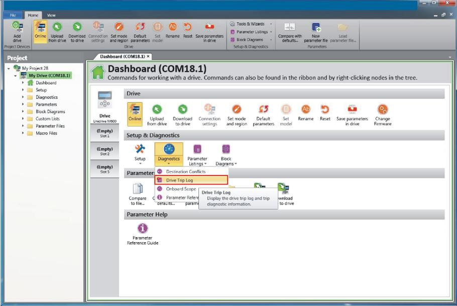
Le journal des mises en sécurité montre la mise en sécurité responsable de l'arrêt de l'autocalibrage et donne une description de la mise en sécurité.
