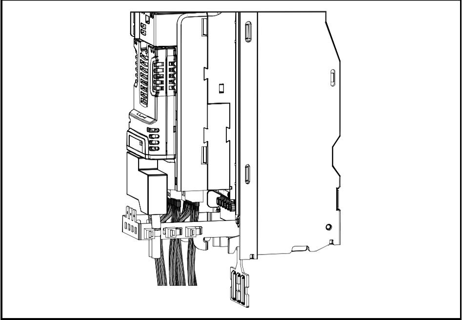
**Câble moteur** : Utiliser un câble moteur muni d'un blindage général. Connecter le blindage du câble moteur à la borne de mise à la terre de la carcasse moteur au moyen d'un raccord aussi court que possible et ne dépassant pas 50 mm. Une connexion du blindage à 360° dans la boîte à bornes du moteur est avantageuse.
