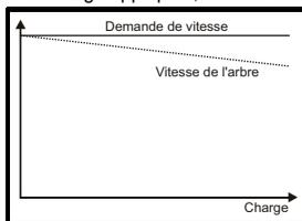
Pour éviter que la vitesse ne diminue comme montré ci-dessus, il est nécessaire d'activer la compensation de glissement. Pour cela, le paramètre Pr 05.027 doit être réglé sur 1 (valeur par défaut) et la vitesse nominale moteur doit être entrée dans Pr 00.045 (Pr 05.008).
