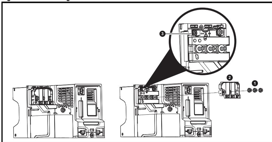
Enlever les trois écrous M5 (1). Soulever le capot (2) afin d'accéder à la vis M4 Torx de démontage du filtre CEM interne. Enlever ensuite la vis M4 Torx de démontage du filtre CEM interne (3) pour déconnecter électriquement ce dernier.
