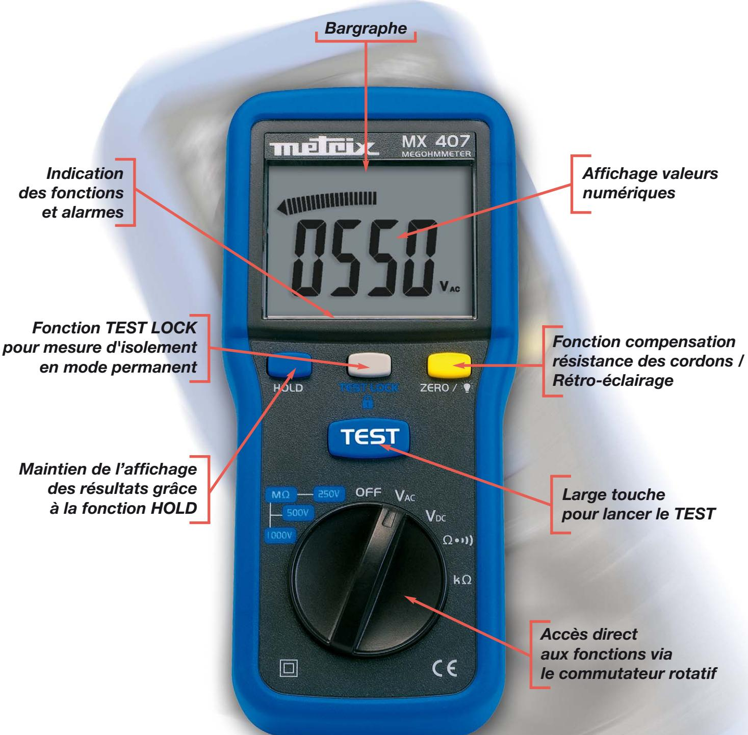
**Sécurité** Le **MX 407** est un appareil sécurisé. En effet, la présence de tension dangereuse est détectée automatiquement. La mesure d'isolement pour une tension supérieure à 25 V est automatiquement inhibée, rendant le test d'isolement impossible.
