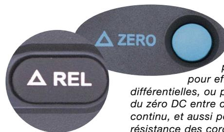
Astucieusement, les touches  $\Delta$  ZÉRO (sur MX 355) et  $\Delta$  REL (sur MX 655 et MX 650) peuvent être utilisées pour effectuer des mesures différentielles, ou pour faciliter le réglage du zéro DC entre chaque mesure de courant continu, et aussi pour compenser la résistance des cordons en mesure  $\Omega$ .
