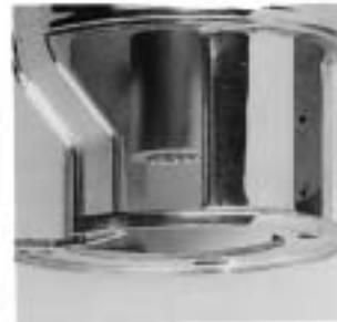
Support moteur et support arbre en microfusion inox AISI 304 soudés de manière rigide à la chemise extérieure en acier inoxydable. Grille aspiration en acier inoxydable.
