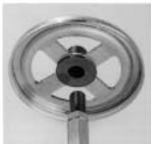
Palier de guidage de l'arbre réalisé avec une douille fermée auto-lubrifiante en polyamide avec bisulfure de molybdène et arbre inox bagué céramique au niveau du point d'usure.
