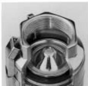
Tête de refoulement en microfusion inox Aisi 304 à double profil conique interne avec clapet anti-retour inox et double oreilles pour filin de suspension.
