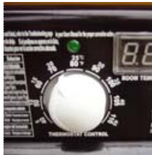
Thermostat intégré avec indicateur de température digital.
