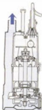
L'eau pompée refroidit le moteur et est refoulée comme illustré ci-contre. Le refroidissement du moteur est également assuré en pompant très peu d'eau. Le refoulement par le dessus permet l'accès à des espaces réduits.
