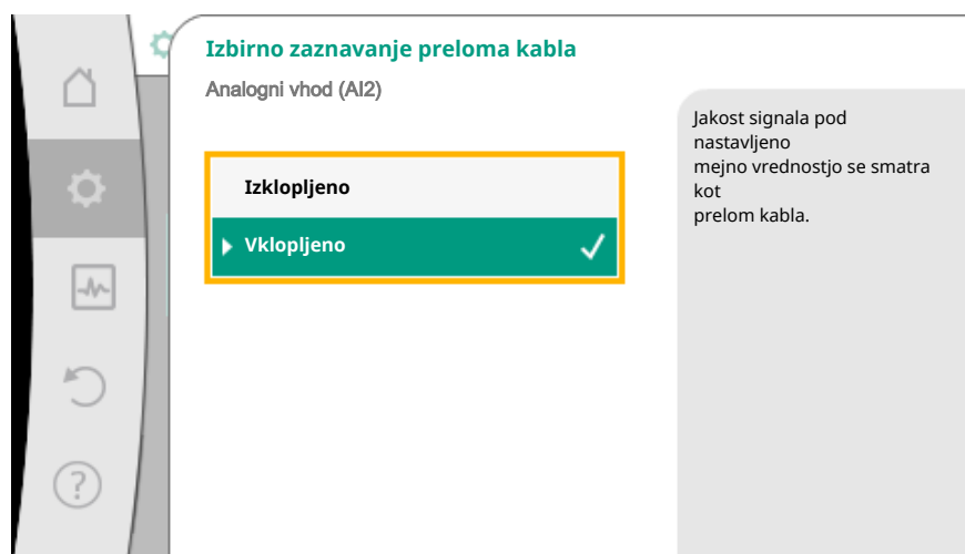
Fig. 71: Izbirno zaznavanje preloma kabla
