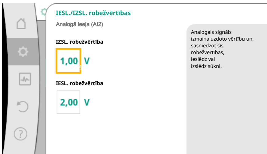
Fig. 74: IESL./IZSL. vadības robežvērtības, izmantojot analogos signālus
