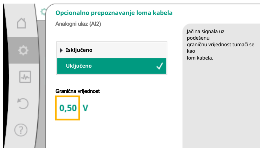
Fig. 72: Granična vrijednost pucanja kabela
