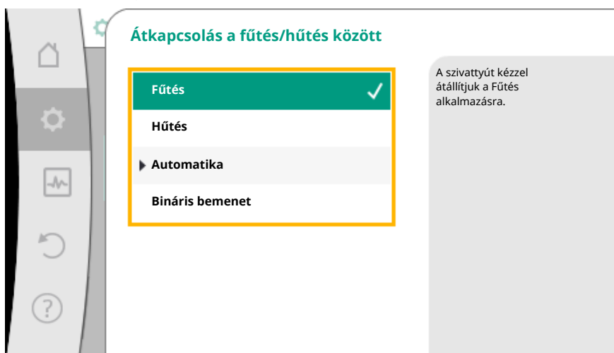
Fig. 54: Átkapcsolás a fűtés/hűtés között_Fűtés
