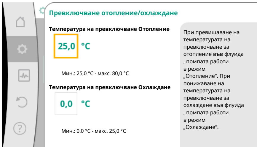
Fig. 57: Превключване отопление/охлаждане_температури на превключване
