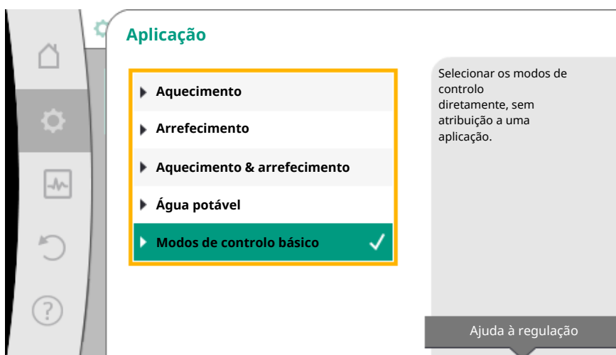
Fig. 50: Seleção da aplicação «Modos de controlo básico»
