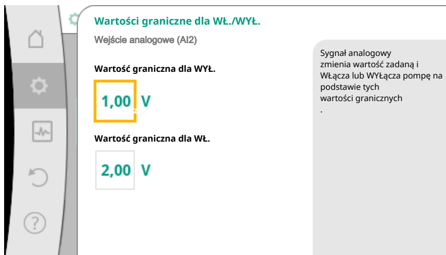
Fig. 74: Wartości graniczne sterowania WŁ./WYŁ. za pomocą sygnałów analogowych Rampa przenoszenia jest teraz zdefiniowana dla transmisji wartości sygnałów analogowych do wartości zadanych. W tym celu określa się minimalne i maksymalne punkty wsparcia charakterystyki pompy oraz związane z nimi wartości zadane (przypisanie sygnału/wartości MIN i przypisanie sygnału/wartości MAX).
