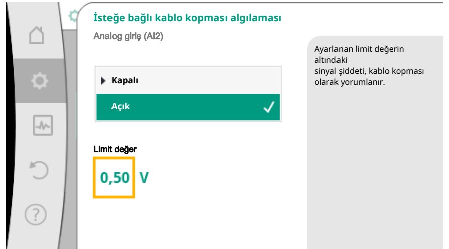
Fig. 72: Limit değer kablo kopması
