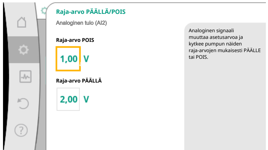
Fig. 74: Raja-arvot PÄÄLLE-/POIS-ohjaukseen analogisten signaalien kautta
