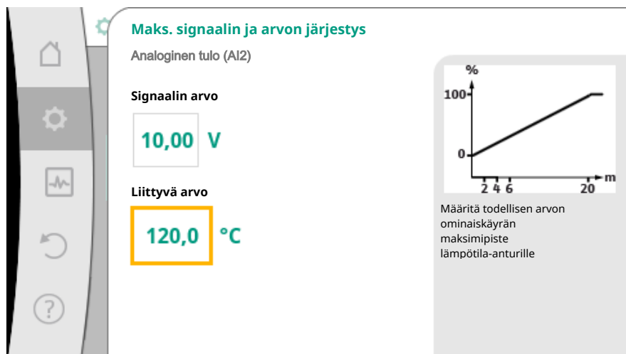
Fig. 81: Maks. signaalin ja arvon järjestys, todellisten arvojen anturi
