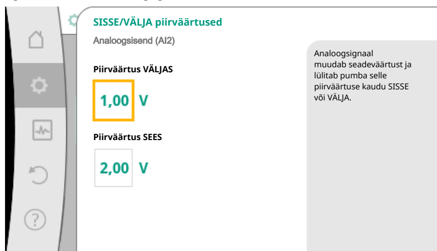
Fig. 74: SISSE/VÄLJA juhtimise piirväärtused analoogsignaali kaudu
