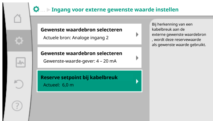
Fig. 77: Reserve setpoint bij kabelbreuk
