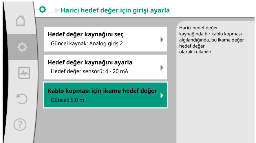
Fig. 77: Kablo kopması için ikame hedef değer
