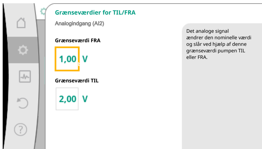
Fig. 74: Grænseværdier til TIL/FRA-styring via analoge signaler
