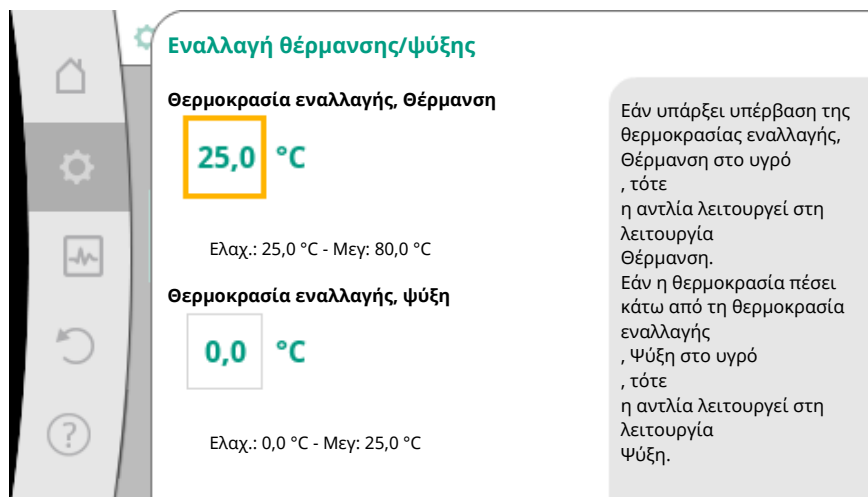
Fig. 57: Εναλλαγή θέρμανση/ψύξη_Θερμοκρασίες εναλλαγής
