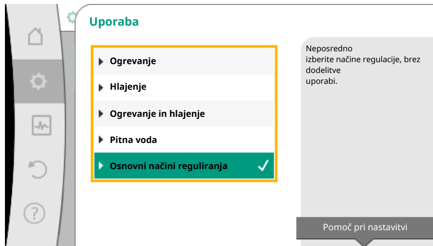
Fig. 50: Izbira uporabe »Osnovni načini regulacije«
