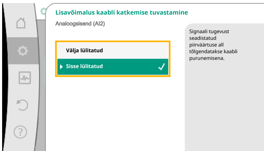
Fig. 71: Lisavõimalus kaabli katkemise tuvastamine
