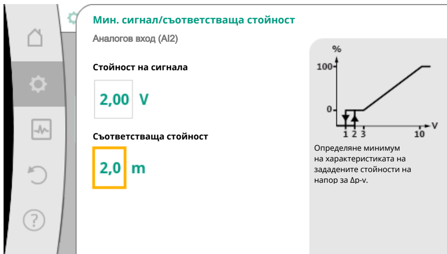
Fig. 75: Мин. сигнал/съответстваща стойност
