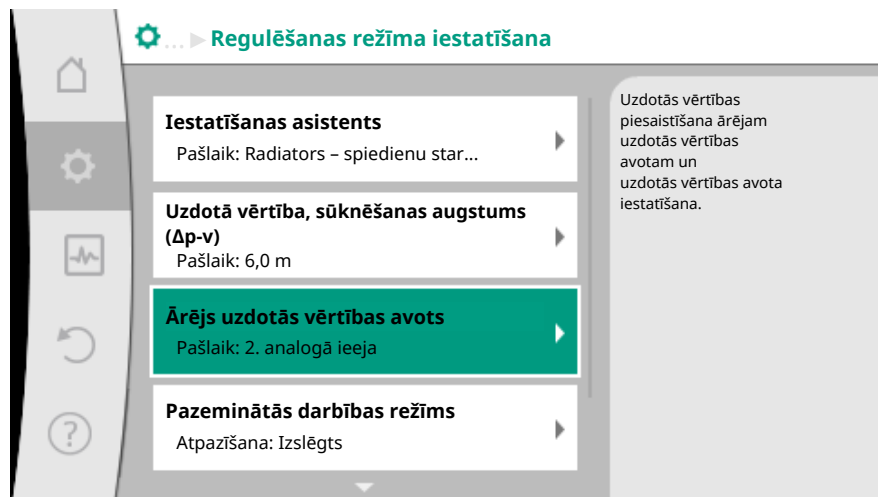
Fig. 66: Ārējs uzdotās vērtības avots
