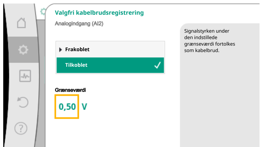
Fig. 72: Grænseværdi for kabelbrud
