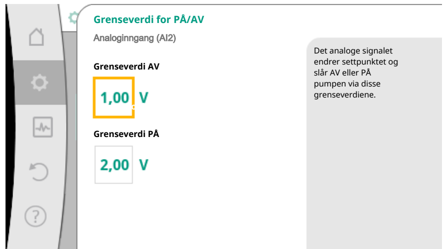
Fig. 74: Grenseverdier for AV/PÅ-styring via analogsignaler
