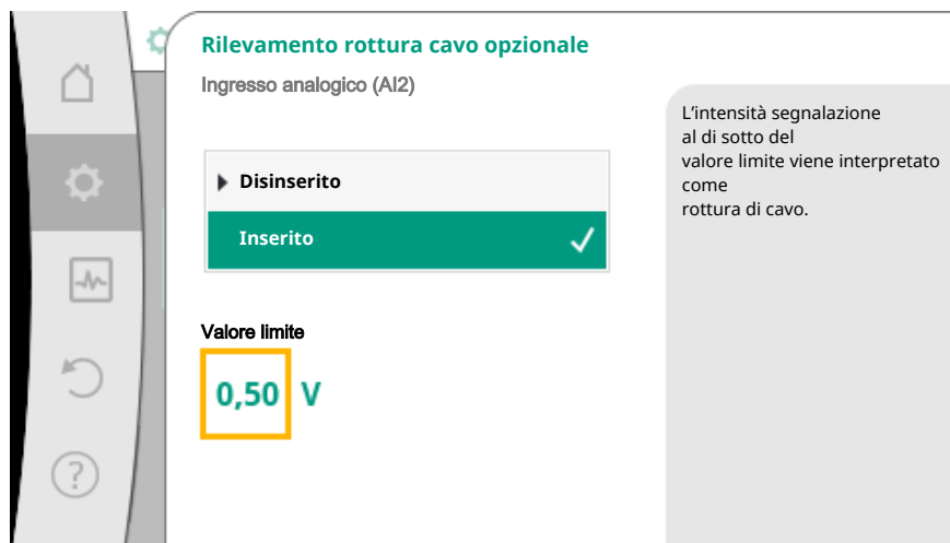
Fig. 72: Valore limite rottura di cavo
