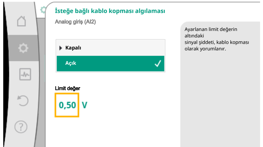
Fig. 72: Limit değeri kablo kopması
