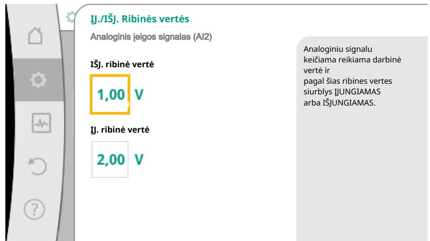
Fig. 74: Įjungimas/išjungimas valdymo analoginiu signalu ribinė vertė
