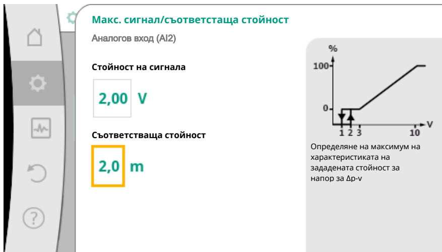
Fig. 76: Макс. сигнал/съответстваща стойност
