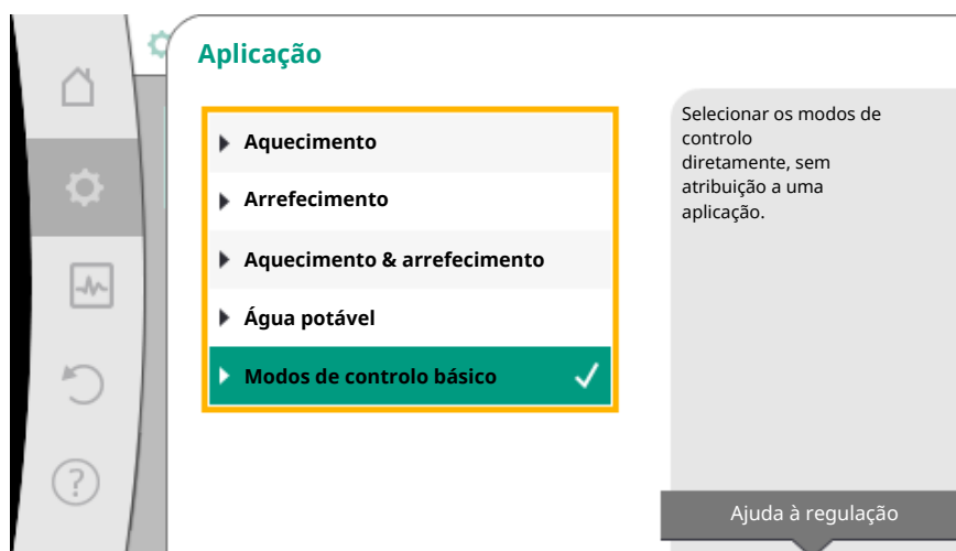
Fig. 50: Seleção da aplicação «Modos de controlo básico»
