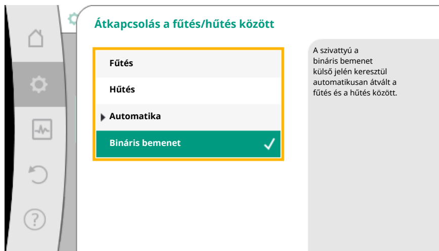
Fig. 58: Átkapcsolás a fűtés/hűtés között_Bináris bemenet
