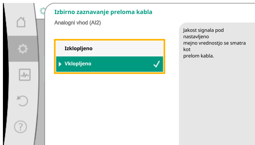
Fig. 71: Izbirno zaznavanje preloma kabla
