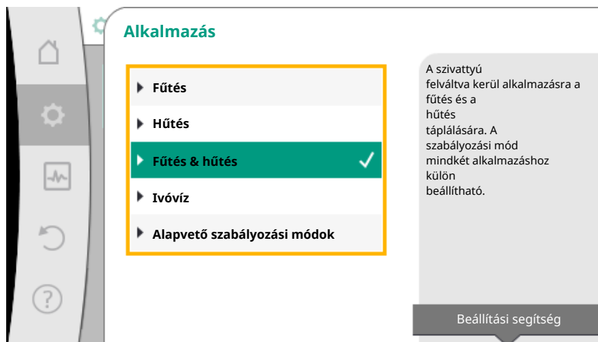
Fig. 51: „Fűtés & hűtés” alkalmazásválasztás
