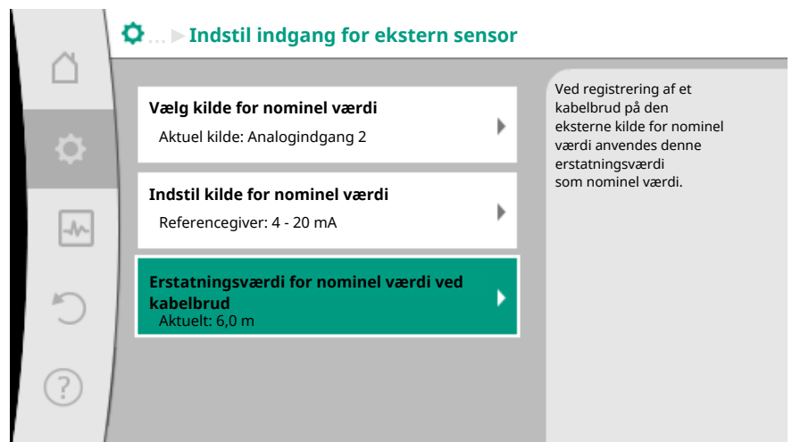
Fig. 77: Erstatningsværdi for nominal værdi ved kabelbrud
