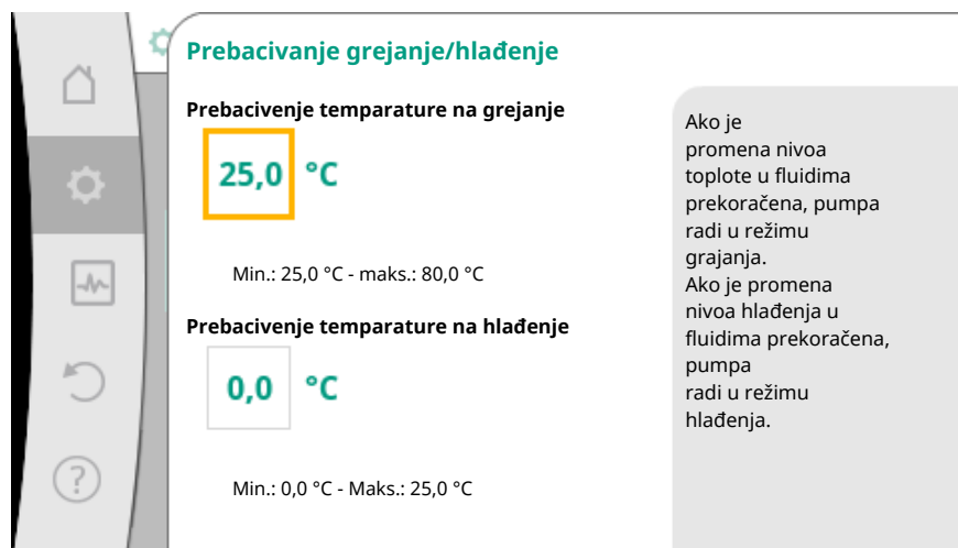
Fig. 57: Prebacivanje grejanje/hlađenje_Prebacivanje temperature
