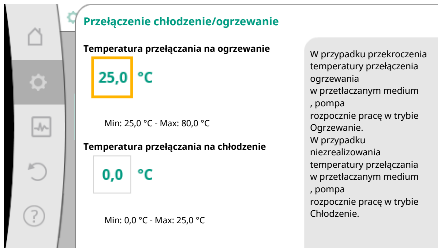
Fig. 57: Przełączenie chłodzenie/ogrzewanie_temperatury przełączania
