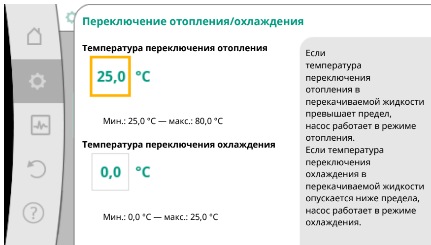
Fig. 57: Переключение отопления/охлаждения_Температуры переключения
