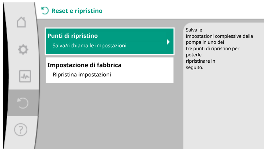
Fig. 85: Punti di ripristino
