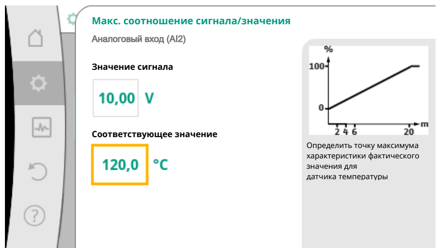
Fig. 81: Макс. соотношение сигнала/значения, датчик фактического значения
