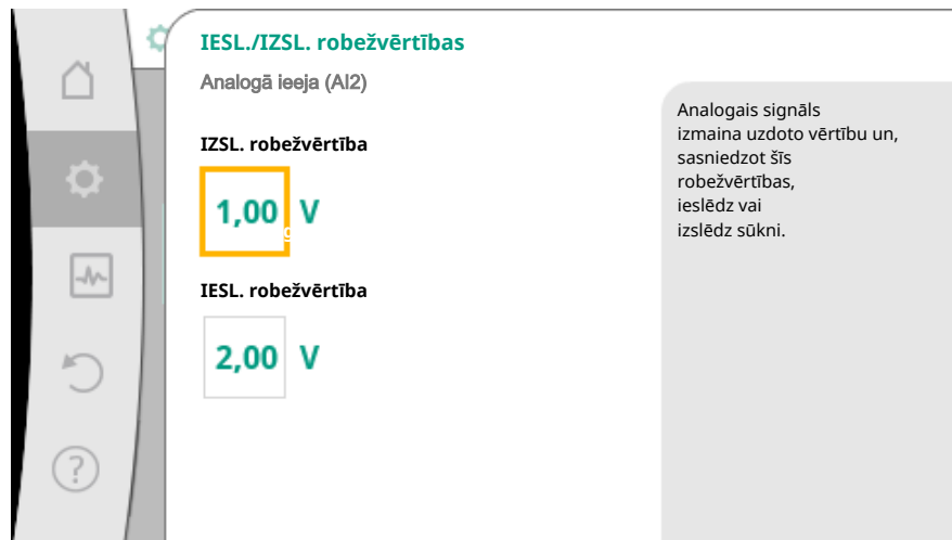
Fig. 74: IESL./IZSL. vadības robežvērtības, izmantojot analogos signālus
