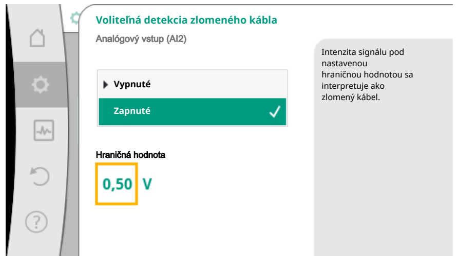
Fig. 72: Hraničná hodnota zlomeného kábla
