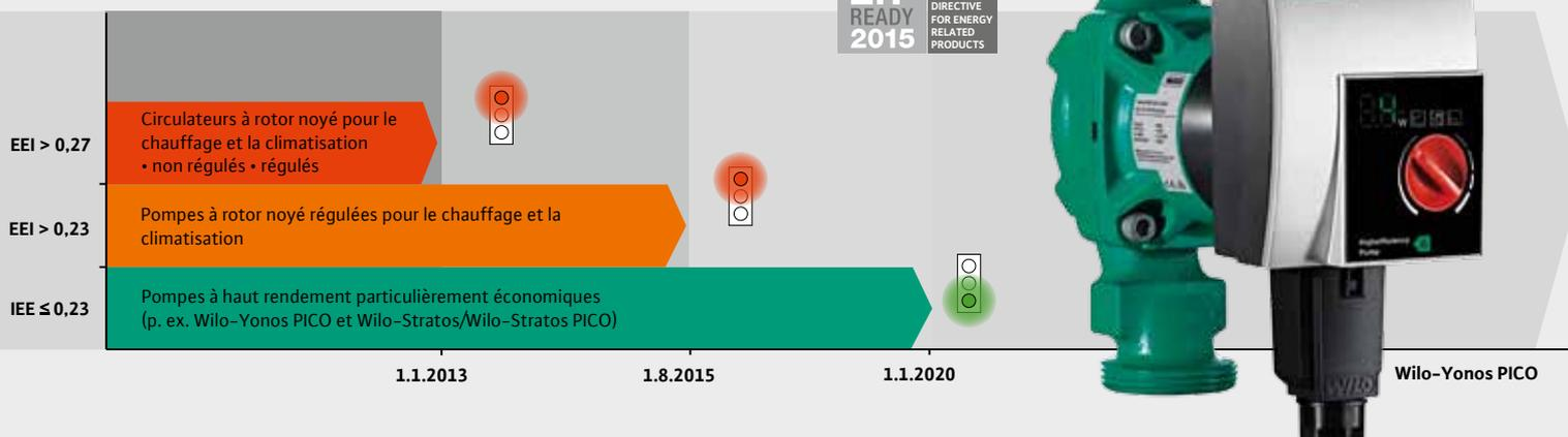
EEI = indice d'efficacité énergétique selon la réglementation (CE) 641/2009 de la Commission européenne (calculé en comparant les différentes puissances absorbées dans un profil de charge avec une pompe de référence à moyenne consommation)
