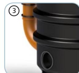
3 Raccordement possible de 3 tuyaux d'entrée eaux usées Ø 160 mm via accouplement rapide avec joints en NBR sans produits d'étanchéité.
