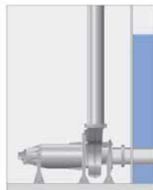
CZ - Installation permanente en position horizontale, hors d'eau ou immergée, avec bride de raccordement sur les conduites d'aspiration et de refoulement.
