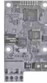
Fig. 73 Grundfos CIM communication interface module
