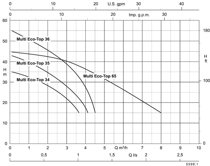
La hauteur manométrique totale de l'installation est la somme de la hauteur d'aspiration + la hauteur de refoulement + les pertes de charge dans la conduite d'aspiration et de refoulement + la pression résiduelle.
